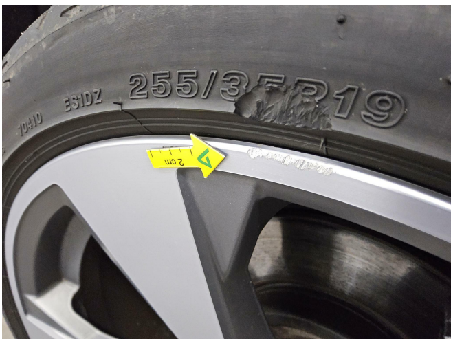
Bild 5: Außen, 2x LM-Felgen, beschädigt, instandsetzen
