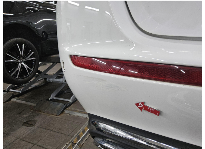
Bild 2: Außen, Stoßfänger hinten, Kratzer, lackieren
