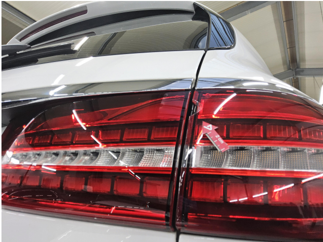
Bild 1: Außen, Rückleuchte rechts, beschädigt, erneuern
