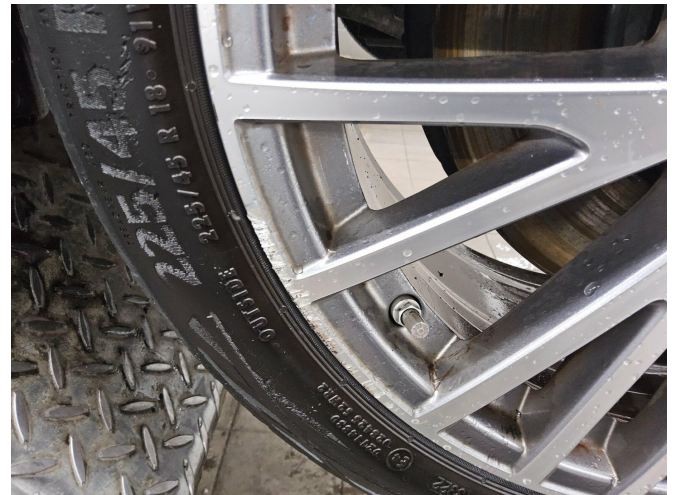
Bild 4: Außen, 2 Leichtmetallfelgen , beschädigt , instandsetzen
