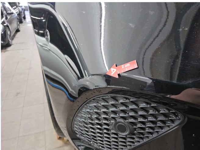
Bild 5: Außen, Stoßfänger vorne, Kratzer , lackieren
