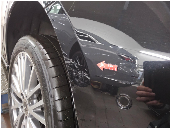
Bild 3: Außen, Stoßfänger hinten, Kratzer , lackieren mit Lackaufbau
