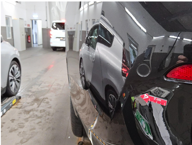
Bild 1: Außen, Stoßfänger hinten, Kratzer , smart repair
